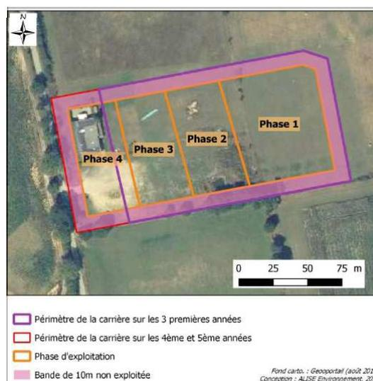
Figure 3 : Plan du phasage de l'exploitation
